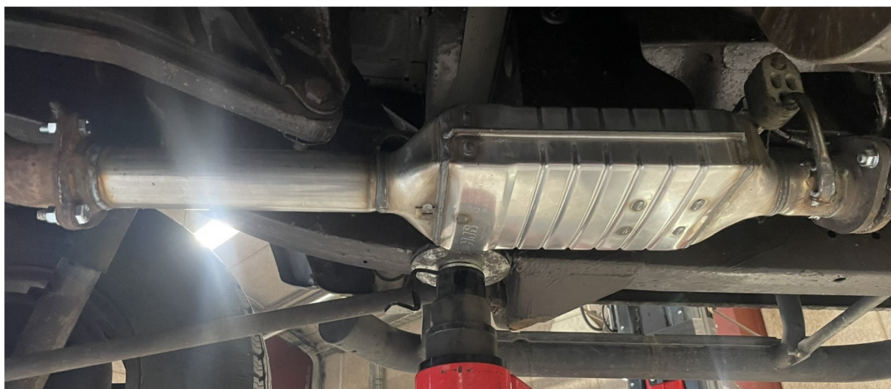
Eksempel 2: HJS DPF-07.12 monteret på Defender 110 2,4 Td4 (foto: Værksted 1, Aalborg) Filteret monteres i stedet for mellempotte. Begge flanger fra lydpotte skåret af og genbrugt.
