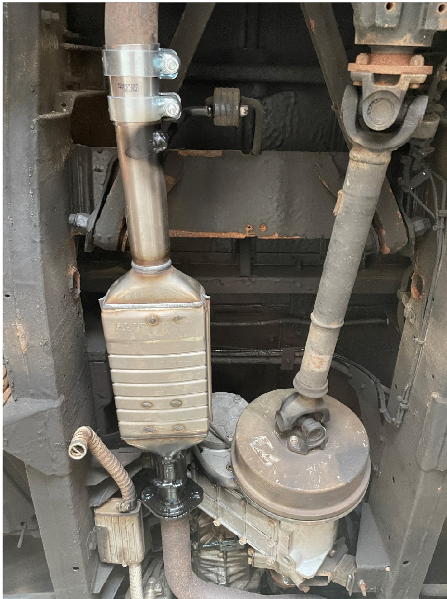
Eksempel 1: HJS DPF-07.12 monteret på Defender 110 2,4 Td4 (foto: US Auto) Filteret monteres i stedet for mellempotte. Forreste flange fra lydpotte skåret af og genbrugt. Bagerst samlet med ø60mm rørsamler. Rundjern til ophæng genbrugt.
